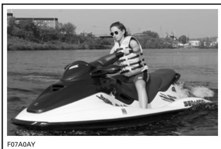
Le déplacement du guidon fait pivoter la tuyère de la turbine pour ainsi diriger la motomarine. Si on tourne le guidon vers la droite, la motomarine tourne à droite, et vice versa. On devrait appuyer sur l'accélérateur pour faire tourner la motomarine.
