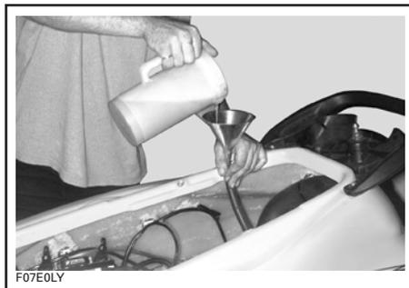
Retirer maintenant le pince-boyau du boyau de purge du tuyau d'échappement calibré. Si nécessaire, continuer de verser du mélange d'antigel dans le moteur jusqu'à ce que la solution colorée sorte par l'autre orifice de purge du système de refroidissement (au niveau de l'oeillet de proue).
