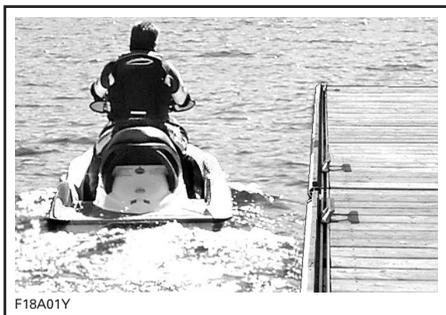
En aguas poco profundas, realice el abordaje desde el otro lado o desde la parte posterior. Asegúrese de que hay, como mínimo, 90 cm (3 pies) de agua por debajo de la sección inferior posterior del casco.
