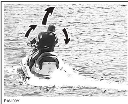
Durch Drehen des Lenkers wird die Strahlpumpendüse geschwenkt, wodurch wiederum die Fahrtrichtung bestimmt wird. Durch Drehen des Lenkers nach rechts schwenkt auch das Fahrzeug nach rechts und umgekehrt. Der Gashebel muss betätigt werden, um das Fahrzeug zu drehen.
