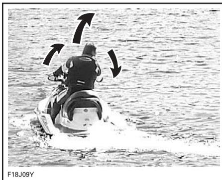
Quand on tourne le guidon, la tuyère de la turbine pivote pour diriger la motomarine. Si on tourne le guidon à droite, la motomarine tourne à droite, et inversement. Appuyer sur l'accélérateur pour faire tourner la motomarine.
