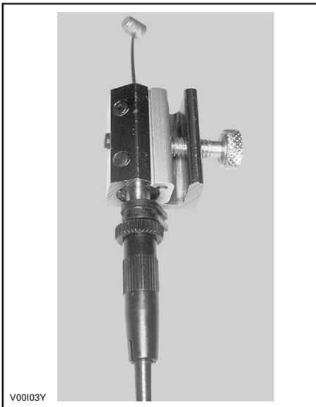
Inserte la aguja de la lata de aerosol en el orificio de lubricación del cable.
