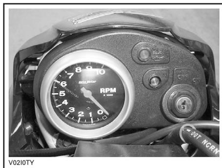
El tacómetro indica las revoluciones por minuto (RPM) del motor. Multiplíquese por 1.000 para obtener una aproximación de las revoluciones reales.
