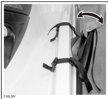
**NOTA:** Quando si rimuove il wakeboard dal supporto, fissare i cavi elastici in maniera tale che non si muovano liberamente durante la guida dell'imbarcazione.
