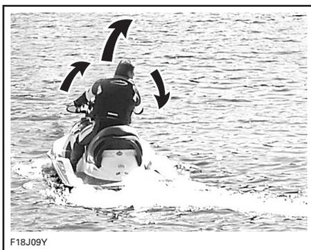
Girando il manubrio, si comandano gli iniettori della pompa a getto che controllano la direzione dell'imbarcazione. Girando il manubrio a destra, l'imbarcazione vira a destra e viceversa. Per girare l'imbarcazione, accelerare.
