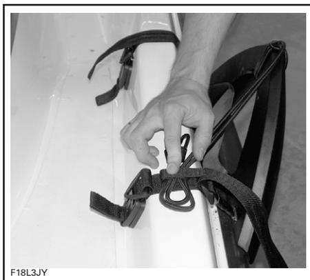
**ATTENZIONE:** Il supporto è progettato per sostenere un solo wakeboard. Non usarlo per più wakeboard o per trasportare sci o altri oggetti. Non usare i supporti come punti di ormeggio o per la risalita nell'imbarcazione.
