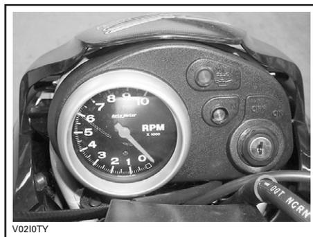
O tacômetro indica a rotação por minuto (RPM) do motor. Multiplique por 1.000 para obter uma aproximação do RPM atual.
