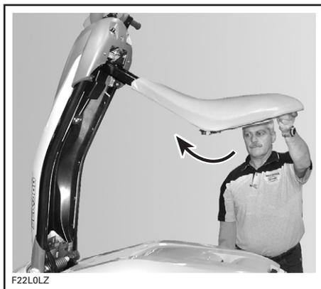
**CUIDADO:** Asegúrese de mantener la columna de dirección a la altura suficiente para que el asiento de "moto" pase limpiamente sobre la tapa del motor al hacer girar el asiento hacia delante y meterlo en la columna.
