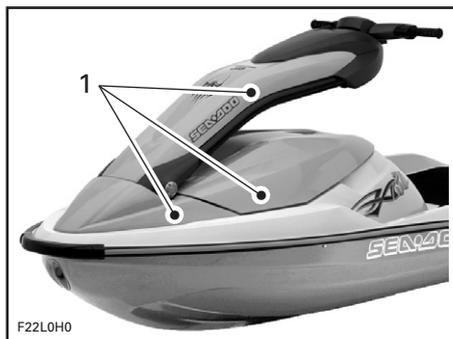
1. Tapa del motor, punta y piezas superiores de la columna de dirección
