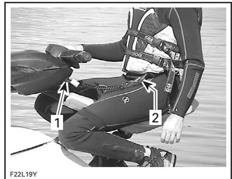
1. Capuchón del dispositivo auxiliar de seguridad en su anclaje
