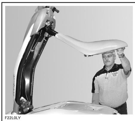
Mantenere il sedile a un'altezza sufficiente a estrarre il canotto del sedile.
