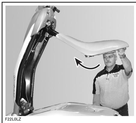
**ATTENZIONE:** Mantenere il piantone di guida a un'altezza tale che il sedile "moto" non urti contro la carenatura del motore quando viene ruotato in avanti nel timone.
