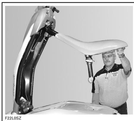
Ruotare il canotto in posizione verticale e spostare il sedile in modo da allineare il canotto al relativo alloggiamento.
