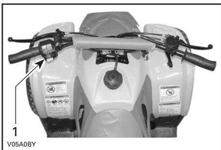
1. Interrupteur multifonctionnel
