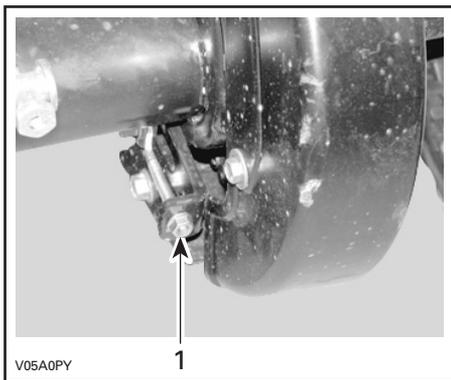
1. Écrou de réglage de la chaîne d'entraînement
