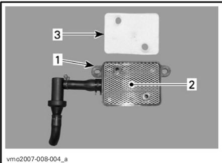
1. Soupape d'injection d'air
