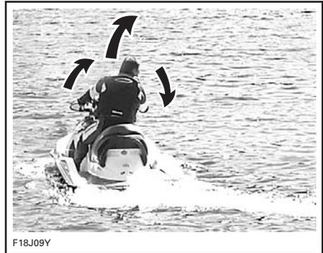
Lorsqu'on tourne le guidon, on fait pivoter la tuyère de la turbine, ce qui dirige la motomarine. Si on tourne le guidon vers la droite, la motomarine tourne à droite, et vice versa. Il faut sur l'accélérateur pour faire tourner la motomarine.
