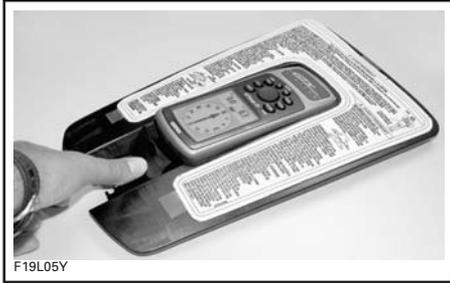
Pour remettre le récepteur à sa place, le pousser jusqu'à ce qu'il se verrouille.
