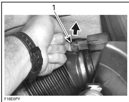
1. Soulever et retenir la languette de verrouillage
