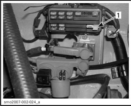
1. Outil d'installation/de dépose de fusibles
