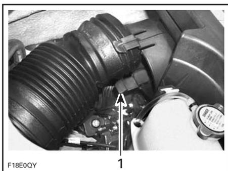
1. Autre languette de verrouillage sous le tube
