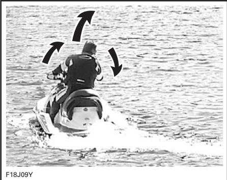
ハンドルバーを回すと、ジェットポンプノズルが軸を中心に向きを変え、ウォータークラフトの進行方向を制御します。ハンドルバーを右に切ると、ウォータークラフトは右へ旋回し、左に切れば左に旋回します。ウォータークラフトを旋回させるときはスロットルを開いてください。
