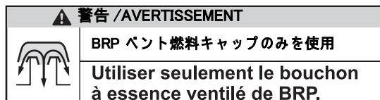
他製品を使用すると、ウォータークラフトの燃料システムの機能が低下します。現在市場には同等品の燃料キャップは無いことに注意してください。
