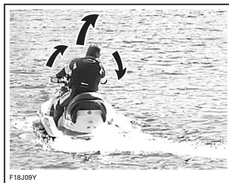
ハンドルバーを回すと、ジェットポンプノズルが軸を中心に向きを変え、ウォータークラフトの進行方向を制御します。ハンドルバーを右に切ると、ウォータークラフトは右へ旋回し、左に切れば左に旋回します。ウォータークラフトを旋回させるときはスロットルを開いてください。
