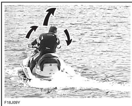
Girando il manubrio, l'iniettore della pompa a getto che controlla la direzione dell'imbarcazione gira su sé stesso. Girando il manubrio a destra, l'imbarcazione vira a destra e viceversa. Per girare l'imbarcazione, accelerare.
