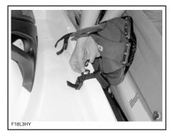
Após a instalação, puxe e empurre o wakeboard para verificar se ele está bem preso no suporte.
