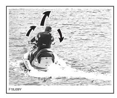
Virando o guidão, o bocal da bomba de jato também vira, controlando a direção da embarcação. Virar o guidão para a direita mudará a direção da embarcação para a direita e vice-versa. O acelerador deve ser usado para mudar a direção da embarcação.
