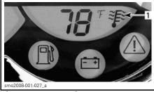
**TÍPICO — EM VELOCÍMETRO** 1. Temperatura da água
