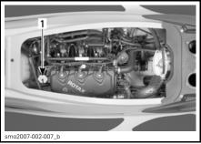
MODELOS SEM TAMPA DO MOTOR 1. Tampa de abastecimento de óleo
