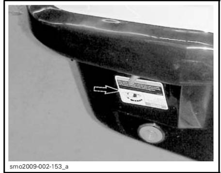
Le moteur 4-TEC<sup>MC</sup> présente un système de protection en cas de chavirement (T.O.P.S.<sup>MC</sup>). Lorsque la motomarine chavire, le moteur s'arrête automatiquement.
