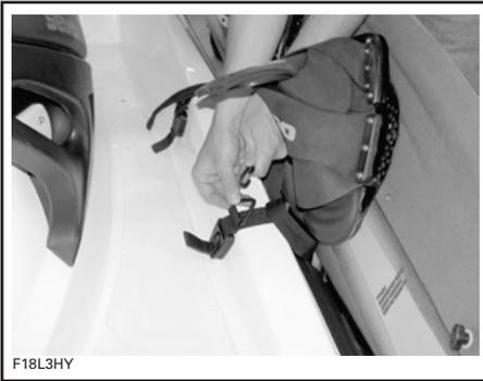
7. Após a instalação, puxe e empurre o wakeboard para verificar se ele está bem preso no suporte.
