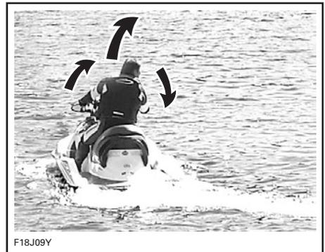
Virando o guidão, o bocal da bomba de jato também vira, controlando a direção da embarcação. Virar o guidão para a direita mudará a direção da embarcação para a direita e vice-versa. O acelerador deve ser usado para mudar a direção da embarcação.
