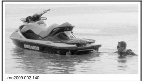
Ergreifen Sie mit der anderen Hand einen der Haltegriffe des Aufsteigetrichters und ziehen Sie sich dann hoch, bis Sie sich auf den Aufsteigetrichter knien können.
