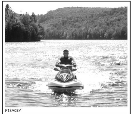
**ZUR BEACHTUNG** Kontrollieren Sie das Wasserfahrzeug, bevor Sie es auf dem Strand verlassen. Stellen Sie sicher, dass die seitlichen Leitflächen durch die Brandung nicht über den Boden schleifen oder aufschlagen. Andernfalls kann es zu einer Beschädigung der Bestandteile des O.P.A.S. Systems kommen.
