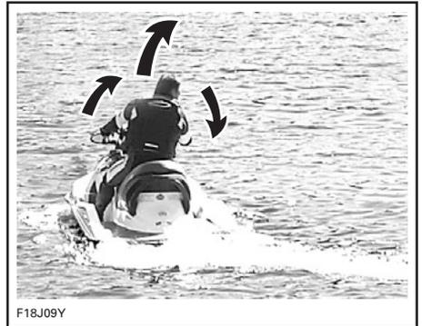
Virar o guidão, gira o bocal da bomba de hidrojato, que controla a direção da motoaquática. Virar o guidão para a direita virará a motoaquática para a direita e vice-versa. O acelerador deve ser usado para virar a motoaquática.
