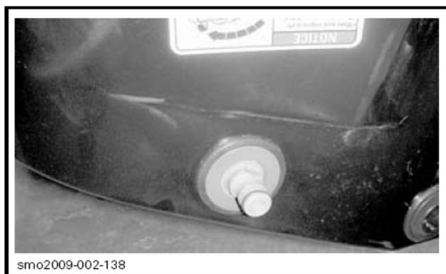
快速连接软管转接头
