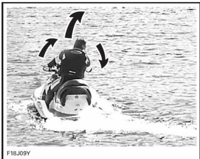
转动手把使喷射泵喷嘴轴转来控制摩托艇方向。转动手把向右会将摩托艇转向右，相反也是一样。应要使用油门来使摩托艇转向。
