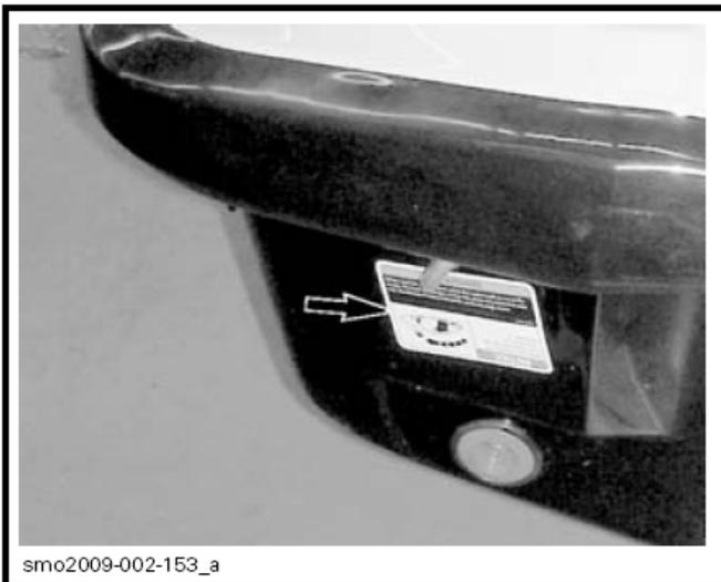
四冲程摩托艇备有翻转保护系统。当摩托艇翻转时，发动机会自动关闭。
