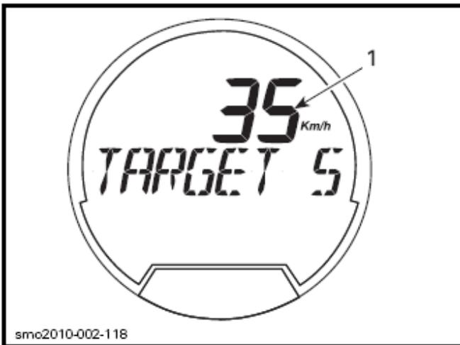
第二个可用设定 – TARGET SPEED (目标速度)
