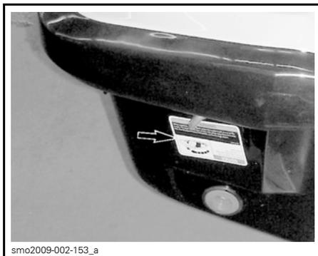
Il motore 4-TEC™ è dotato di un sistema anticapovolgimento (T.O.P.S.™). Quando l'imbarcazione si capovolge, il motore si spegne automaticamente.
