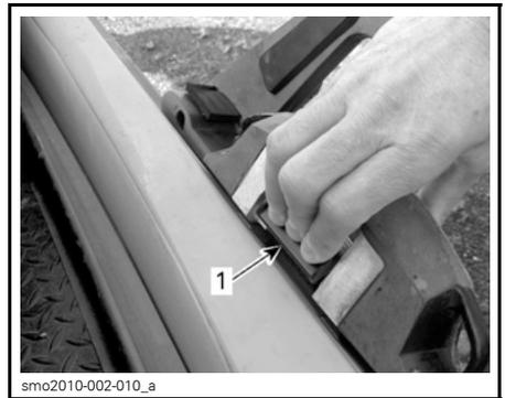
**RIMOZIONE DEL SUPPORTO DEL WAKEBOARD**
