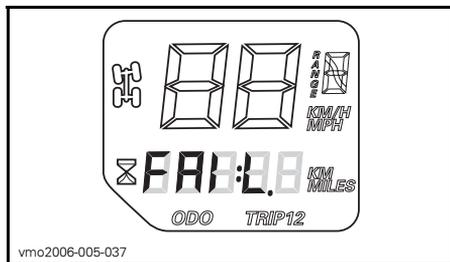
Wenn Ihr Tachometer **FAIL** in der Multifunktionsanzeige anzeigt, bedeutet dies, dass der Tachometer 18 V in der elektrischen Anlage gemessen hat. Diese wird durch einen abgeklemmten oder defekten Spannungsregler verursacht.
