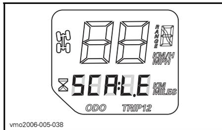
Wenn Ihr Tachometer auf der Multifunktionsanzeige **SCALE** anzeigt, bedeutet dies, dass die Anzeigewahltaste in der unteren Stellung klemmt oder bei Aktivierung der elektrischen Anlage niedergedrückt wurde.
