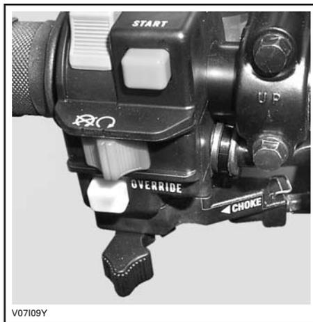
**CHOKE LEVER IN THE FULL CHOKE POSITION**
