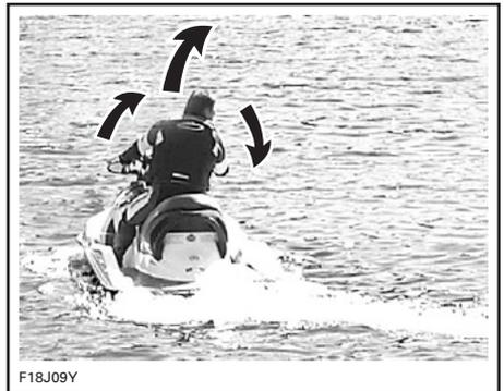
Girando il manubrio, l'iniettore della pompa a getto che controlla la direzione dell'imbarcazione gira su sé stesso. Girando il manubrio a destra, l'imbarcazione vira a destra e viceversa. Per girare l'imbarcazione, accelerare.
