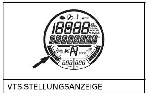
Das VTS ermöglicht eine manuelle Anpassung der Trimmung der Düse. Bei manchen Modellen hat man auch die Wahl zwischen zwei Trimm-Voreinstellungen und man kann neue Voreinstellungen speichern bzw. die vorhandenen ändern.
