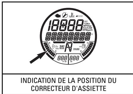
Le correcteur d'assiette permet d'ajuster manuellement la position de la tuyère, de présélectionner deux positions et d'enregistrer ou de modifier des positions du correcteur d'assiette pour certains modèles.
