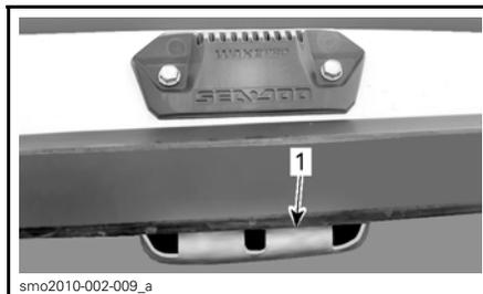
1. Partie à crochets du support dans l'étrier inférieur
