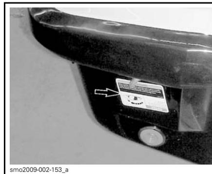
Le moteur 4-TEC<sup>MC</sup> présente un système de protection en cas de chavirement (T.O.P.S.<sup>MC</sup>). Lorsque la motomarine chavire, le moteur s'arrête automatiquement.
