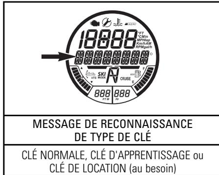
La clé d'apprentissage Sea-Doo et la clé de location limitent la vitesse de la motomarine et le couple du moteur. Les conducteurs novices ou peu expérimentés peuvent ainsi apprendre à conduire une motomarine tout en acquérant la confiance et la maîtrise nécessaires.
