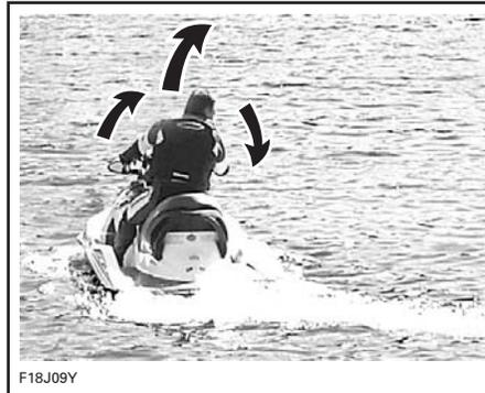
Lorsqu'on tourne le guidon, on fait pivoter la tuyère de la turbine, ce qui dirige la motomarine. Si on tourne le guidon vers la droite, la motomarine tourne à droite, et elle tourne à gauche lorsqu'on tourne le guidon à gauche. Il faut appuyer sur l'accélérateur pour faire tourner la motomarine.
