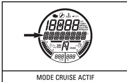
Un bip indiquant que le mode régulation de vitesse est actif retentira et l'indicateur CRUISE s'allumera sur l'indicateur multifonctionnel.
