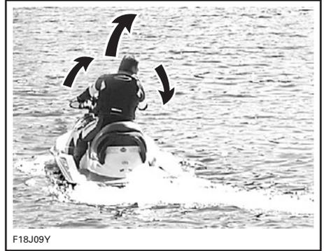
Virar o guidão, gira o bocal da bomba de jato, que controla a direção do jet. Virar o guidão para a direita virará o jet para a direita e vice-versa. O acelerador deve ser usado para virar o jet.
