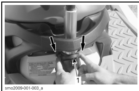
EMPURRE NA DIREÇÃO DA PROA PARA DESTRAVAR E REMOVER O MASTRO
