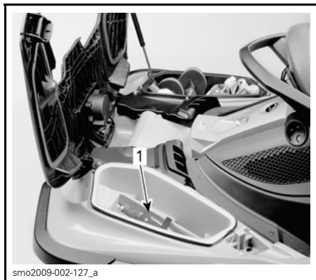
1. Localização do suporte do extintor de incêndio
