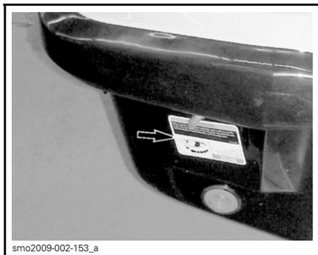
Der 4-TEC™ Motor verfügt über einen Kippschutz (T.O.P.S.™). Wenn das Fahrzeug kentert, wird der Motor automatisch angehalten.
