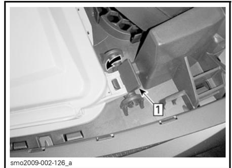
Schritt 1: Zum Sichern auf die Verriegelungen drücken
