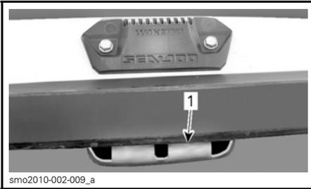
1. Hakenteil der Halterung an unterem Haltebeschlag
