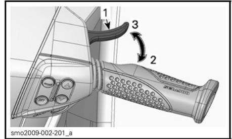
1. Palanca del acelerador
