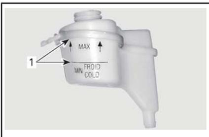
**CONFIGURAZIONE TIPICA - SERBATOIO A ESPANSIONE DEL LIQUIDO REFRIGERANTE**
