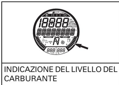
Quando il serbatoio del carburante è pieno, 8 segmenti dell'indicatore (barre) sono accesi. L'ultimo segmento non viene utilizzato.
