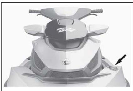
*CONFIGURAZIONE TIPICA - UBICAZIONE DEL TAPPO DEL SERBATOIO DEL CARBURANTE*
