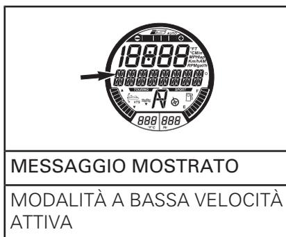
L'indicazione del punto di impostazione sullo schermo digitale comparirà nuovamente per indicare il cambiamento della bassa velocità impostata.
