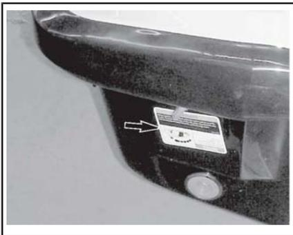
Il motore 4-TECT™ è dotato di un sistema anticapovolgimento (T.O.P.S.™). In caso di capovolgimento dell'imbarcazione, il motore si arresta automaticamente.
