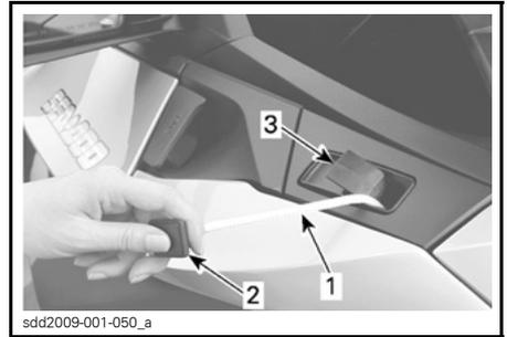
**TÍPICA - CABO RETRÁTIL DIANTEIRO**
