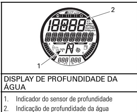
NOTA: O display de profundidade da água só está disponível quando um sensor de profundidade estiver instalado e detectado.
