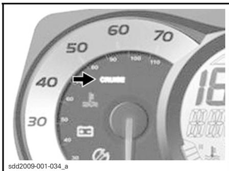
**TÍPICA - LUZ INDICADORA DO MODO CRUIZEIRO NO VELOCÍMETRO**
