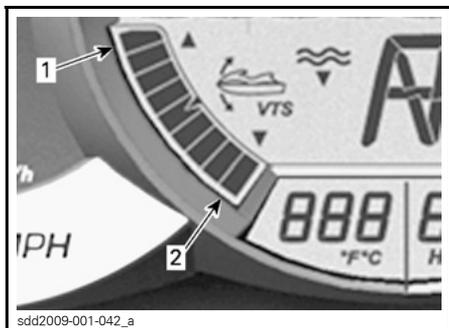
O sistema VTS permite ajustar manualmente a posição de ajuste do bocal, ou seleccionar duas posições de ajuste predefinidas e registar ou alterar as posições de ajuste de alguns modelos.
