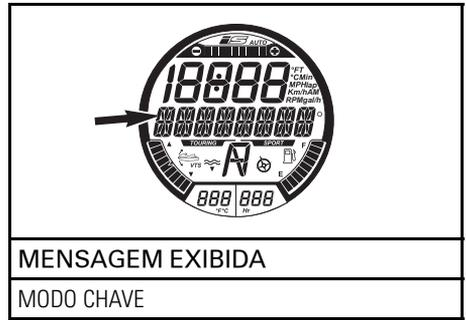
4. Pressione o botão SET uma vez para ativar a função do modo de configuração da chave Aprendizado. O display mudará para chave L.
