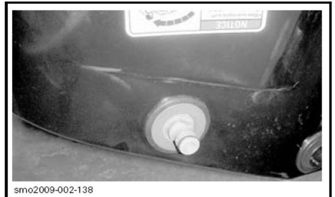
典型图示 – 快速连接软管转接头
