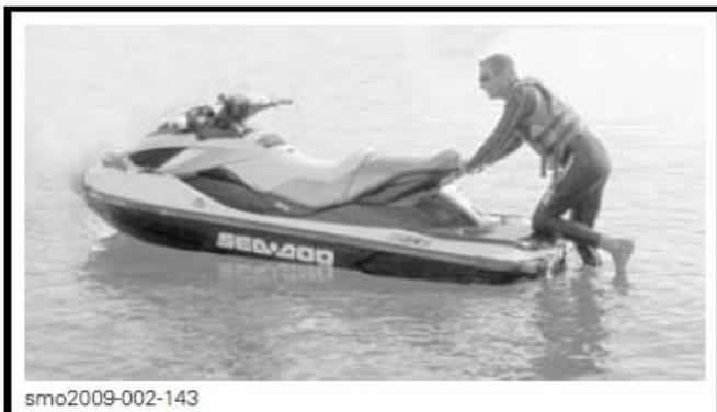
在波浪起伏的水面上，乘客在水中可扶住摩托艇来帮助操作员爬上摩托艇。
