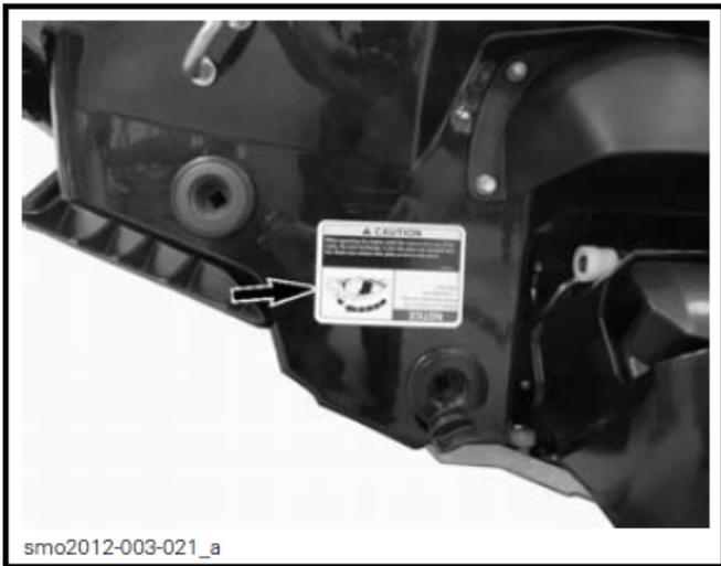
四冲程发动机备有 TOPS (翻转保护系统)。当摩托艇翻转时，发动机会自动关闭。
