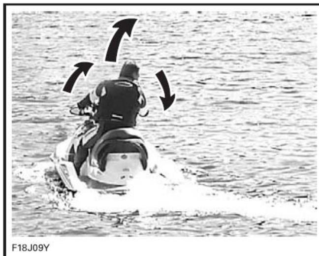
转动把手使喷射泵喷嘴轴转来控制摩托艇方向。转动把手向右会将摩托艇转向右，转动把手向左会将摩托艇转向左。应要使用油门来使摩托艇转向。
