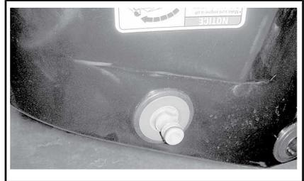
TÍPICO - ADAPTADOR DE MANGUERA DE CONEXIÓN RÁPIDA
