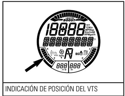
El sistema VTS permite ajustar manualmente la posición de elevación (trim) de la tobera, seleccionar dos posiciones de trim predefinidas y registrar o cambiar posiciones de trim predefinidas en algunos modelos.
