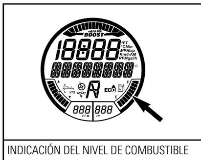
Cuando el depósito está lleno, aparecen encendidas ocho barras del indicador. El segmento superior no se utiliza.
