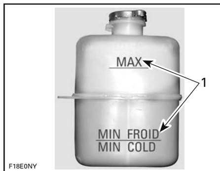
**TIPOQUE - RÉSERVOIR D'EXPANSION DU SYSTÈME DE REFROIDISSEMENT**
