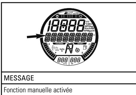
7. Appuyer sur le bouton SET pour sélectionner la fonction iBR MANUEL ACTIVÉ. L'indicateur reviendra en mode normal.
