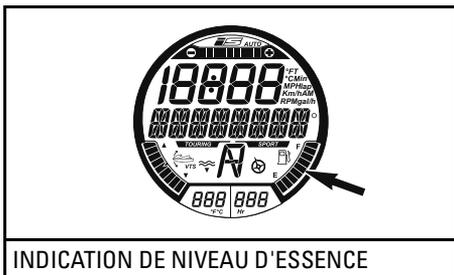
Lorsque le réservoir est plein, 8 segments (barres) de l'indicateur de niveau sont allumés. Le segment supérieur n'est pas utilisé.
