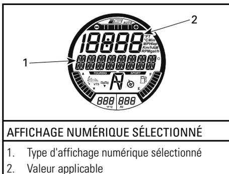
4. Appuyer sur le bouton SET pour sélectionner et sauvegarder un affichage ou attendre que la fonction d'affichage disparaisse d'elle-même. Le dernier affichage visible sera automatiquement sauvegardé.
