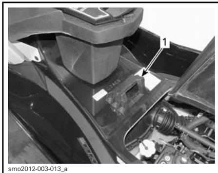
1. Dispositif de retenue avant du siège
