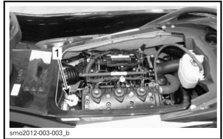
1. Emplacement du bouchon de remplissage d'huile
