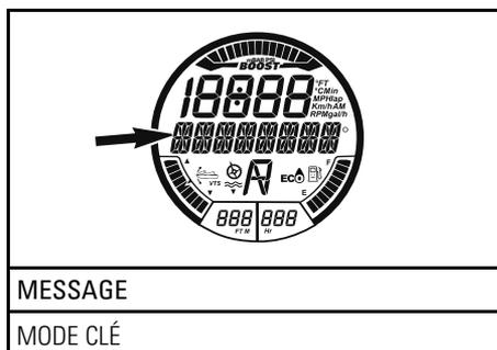
4. Appuyer sur le bouton SET pour activer la fonction de réglage de la clé d'apprentissage. Le message L-Key s'affichera sur l'indicateur.
