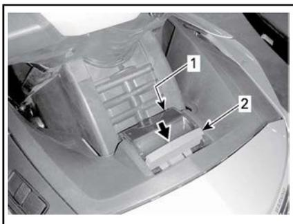
**TRAVA DE AJUSTE DA COLUNA DE DIREÇÃO NÃO ENCAIXADA**
