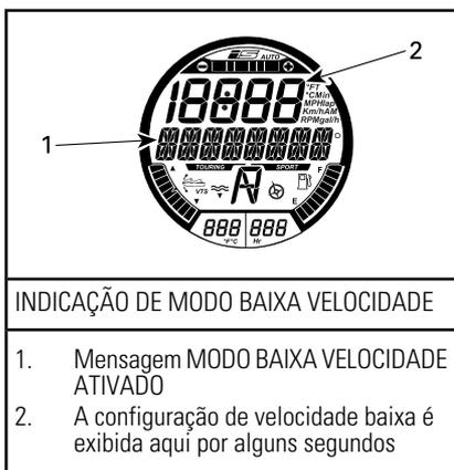
**NOTA:** A mensagem circulante MODO BAIXA VELOCIDADE repete-se enquanto o modo de baixa velocidade estiver ativado. O display numérico volta para a indicação anterior após alguns segundos.
