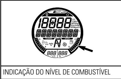
Quando o tanque de combustível está cheio, oito segmentos (barras) do indicador ficam acesas. O segmento superior não é usado.
