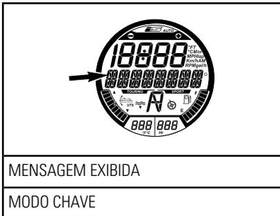
4. Pressione o botão SET (Definir) uma vez para ativar a função do modo de configuração da chave Aprendizado. O display mudará para chave L.
