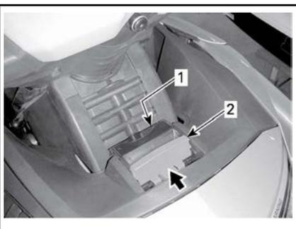
**TRAVA DE AJUSTE DA COLUNA DE DIREÇÃO ENCAIXADA CORRETAMENTE**
