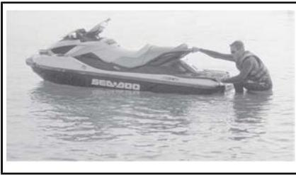
Com as duas mãos no puxador atrás do assento, suba para a plataforma de embarque.
