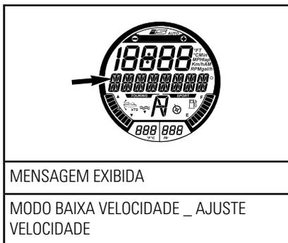
A indicação do ponto de ajuste na tela digital ficará ativa novamente para indicar a alteração da configuração de baixa velocidade.
