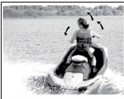
Virar o guidão, gira o bocal da bomba de jato, que controla a direção do jet. Virar o guidão para a direita gira o jet para a direita. Virar o guidão para a esquerda vira o jet para a esquerda. O acelerador deve ser usado para virar o jet.
