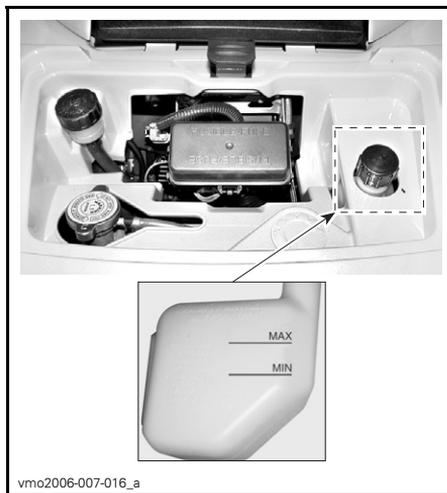
Wenn das Fahrzeug auf einer ebenen Fläche abgestellt ist, muss sich der Kühlflüssigkeitsstand zwischen der MIN.- und MAX.-Markierung auf dem Kühlflüssigkeitsbehälter befinden.
