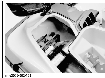
电池和保险丝通道 - 右边储物箱拆除
