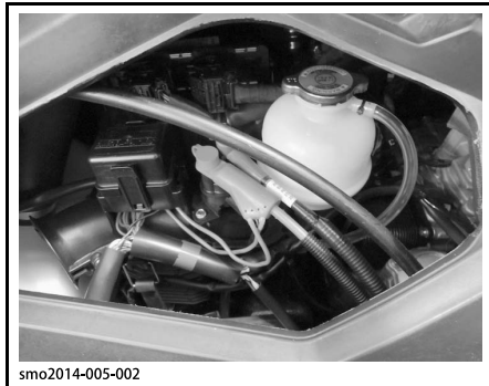
发动机存储箱 - 移除左边通道盖
