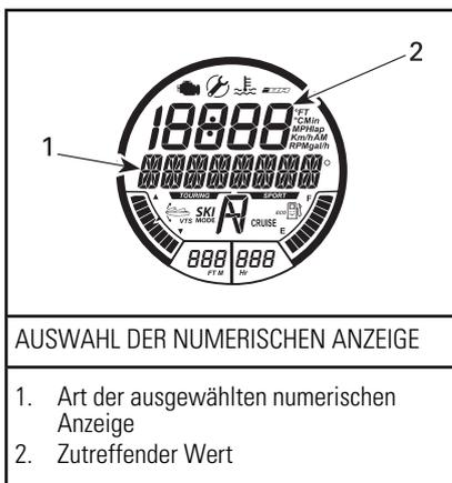
4. Drücken Sie die Taste **SET** (Einstellung), um die gewünschte Information auszuwählen und zu speichern, oder warten Sie, bis die Funktion automatisch beendet wird. Die zuletzt angezeigte Information wird automatisch gespeichert.
