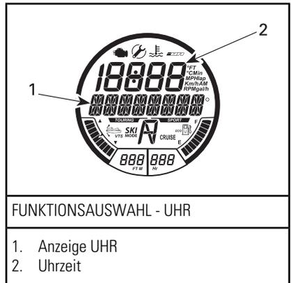
3. Drücken Sie die Taste SET (Einstellung), um die Funktion einzugeben. Die Meldung UHR EINSTELLEN wird angezeigt.
