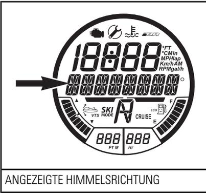
**HINWEIS:** Die Kompassanzeige steht nur bei einer Geschwindigkeit über 5 km/h zur Verfügung.
