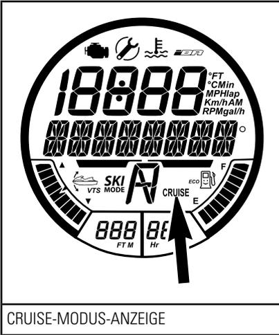
Eine Meldung läuft durch die Multifunktionsanzeige, um darauf hinzuweisen, dass Sie sich jetzt im Niedriggeschwindigkeitsmodus befinden. Die Niedriggeschwindigkeitsstandardvorgabe 1 erscheint ebenfalls einige Sekunden in der numerischen Anzeige.
