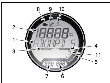
**HINWEIS:** Wenn ein Fehler auftritt, durchläuft die jeweilige Fehlermeldung in regelmäßigen Abständen die Anzeige. Je nach Schwere des entdeckten Fehler kehrt die Anzeige nach jedem Durchlaufen der jeweiligen Fehlermeldung zur Darstellung der Drehzahl zurück.
