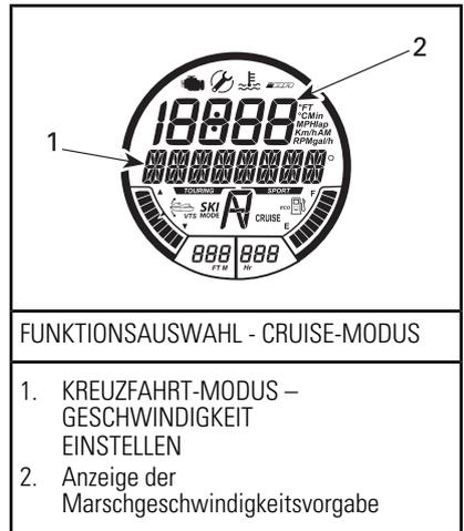
**HINWEIS:** Durch wiederholtes Drücken der Taste HINAUF/HINAB wird die eingestellte Geschwindigkeit für den Cruise-Modus in einzelnen Schritten geändert. Wenn die Taste gedrückt gehalten wird, wird die Geschwindigkeit erhöht oder verringert, bis die Taste losgelassen wird.
