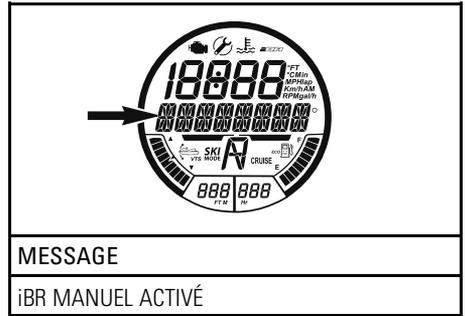
7. Appuyer sur le bouton SET pour sélectionner la fonction iBR MANUEL ACTIVÉ. L'indicateur reviendra en mode normal.
