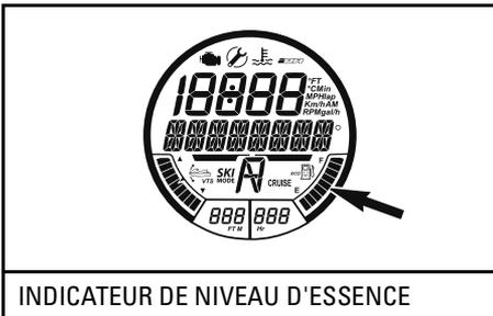
Lorsque le réservoir est plein, 8 segments (barres) de l'indicateur sont allumés. Le segment du haut est inutilisé.
