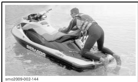
Agrripper la courroie du siège pour maintenir son équilibre et avancer jusqu'aux repose-pieds de chaque côté du siège.
