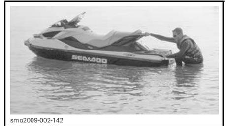
Agripper des deux mains la poignée de maintien à l'arrière du siège et monter sur la plate-forme d'embarquement.
