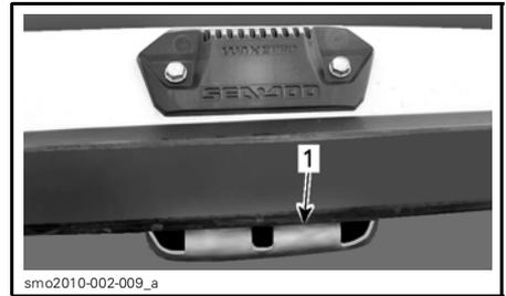
1. Partie à crochets du support dans l'étrier inférieur
