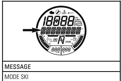
3. Appuyer sur le bouton SET pour choisir la fonction. Le message de l'indicateur multifonctionnel affichera RAMPE. Le numéro de RAMPE apparaîtra à l'affichage numérique.
