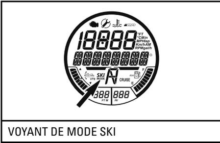
9. Pour démarrer la motomarine en mode ski, tirez et retenez le levier de l'accélérateur jusqu'au guidon. La motomarine accélérera selon le réglage de la VITESSE CIBLE et le voyant du MODE SKI indiquera une vitesse constante.
