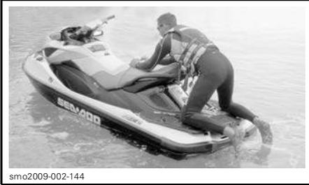
4. Agripper la courroie du siège pour maintenir son équilibre et avancer jusqu'aux marchepieds de chaque côté du siège.
