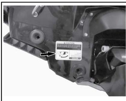
O motor possui um sistema de proteção contra emborcamentos (T.O.P.S.™). Quando o jet vira, o motor desliga automaticamente.
