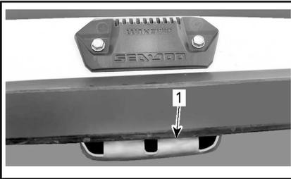
1. Hakenteil der Halterung an unterem Haltebeschlag
