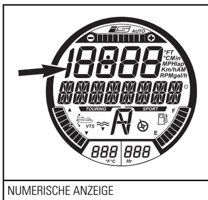
Wenn sich das Federungssystem im Modus AUTO befindet, sind die Anzeige AUTO und alle Balkensegmente der Positionsanzeige eingeschaltet.
