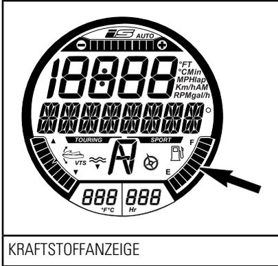
Wenn der Kraftstoffbehälter voll ist, sind 8 Segmente (Balken) der Anzeige aktiv. Das obere Segment wird nicht verwendet.
