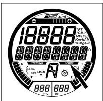
スポーツモードインジケーター (RXT-X/RXT-X aS以外のすべてのモ デルに適用) スポーツモードの操作を選択すると、スポーツモードインジケーターが点灯し、スポーツモードを解除するか、ウォータークラフトを停止するまで点灯し続けます。
