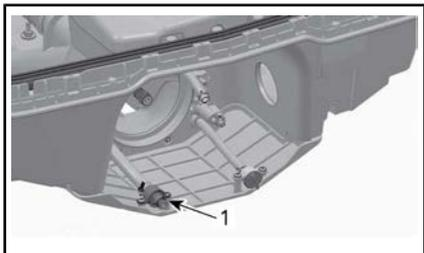
**DIE STRAHLDÜSE WURDE AUS GRÜNDEN DER ÜBERSICHTLICHKEIT ENTFERNT**
