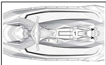
1. Schrauben an der hinteren Stütze
