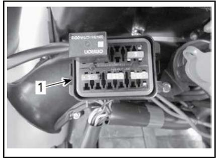
**TYPISCH - SICHERUNGSKASTEN ENTFERNT**
