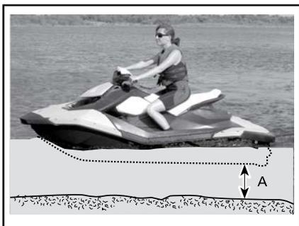
A. Sorgen Sie dafür, dass mindestens 90 cm Wasser unter dem am tiefsten liegenden hinteren Teil des Rumpfes liegen, wenn alle Mitfahrer an Bord sind
