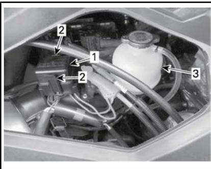
1. Abdeckung des Sicherungskastens
