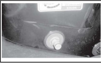
TÍPICO - ADAPTADOR DE MANGUERA DE CONEXIÓN RÁPIDA
