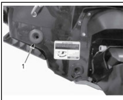
1. Position des Spülanschlusses
