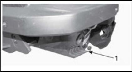
1. 左侧图示 — 平衡翼片
