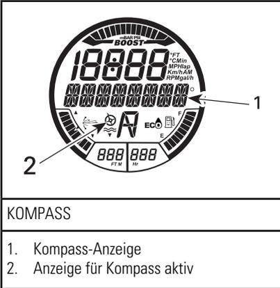
**HINWEIS:** Die Kompassanzeige steht nur bei einer Geschwindigkeit über 5 km/h zur Verfügung.
