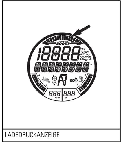
Die Ladedruckanzeige zeigt den vom Turbolader erzeugten Ladedruck des Motors an.
