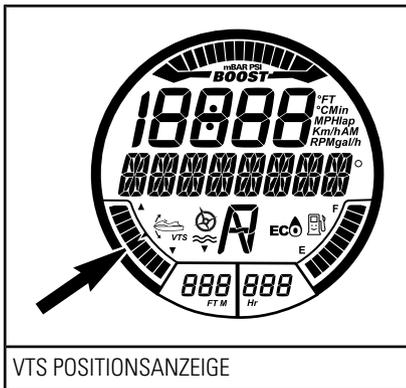
Das VTS ermöglicht eine manuelle Anpassung der Trimmung der Düse. Bei manchen Modellen hat man auch die Wahl zwischen zwei Trimm-Voreinstellungen und man
